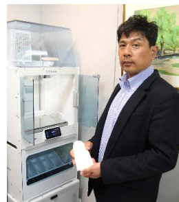
▲足底装具（インソール）モデルを出力する3Dプリンター
