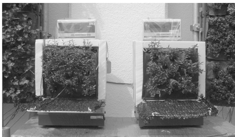
写真2 電子秤を使用した蒸発散量の計測状況
